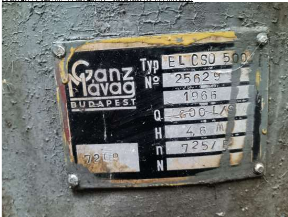
A meglévő szivattyút meghajtó villanymotor adattáblája:
